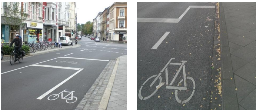
Bild 38: Aufgeweiteter Radaufstellstreifen und vorgezogene Haltlinie
