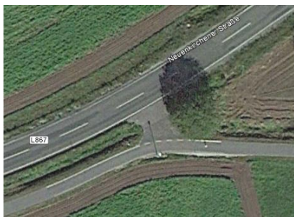
Neuenkirchener Straße: Kein Übergang von Fahrbahnführung zu einseitigem Geh-/Radweg
