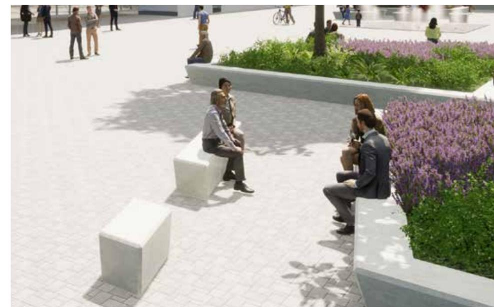
Rendering Sitzbänke aus hellen Sichtbeton mit Graphiti- und Skaterschutz und hydrophobisierender Beschichtung
