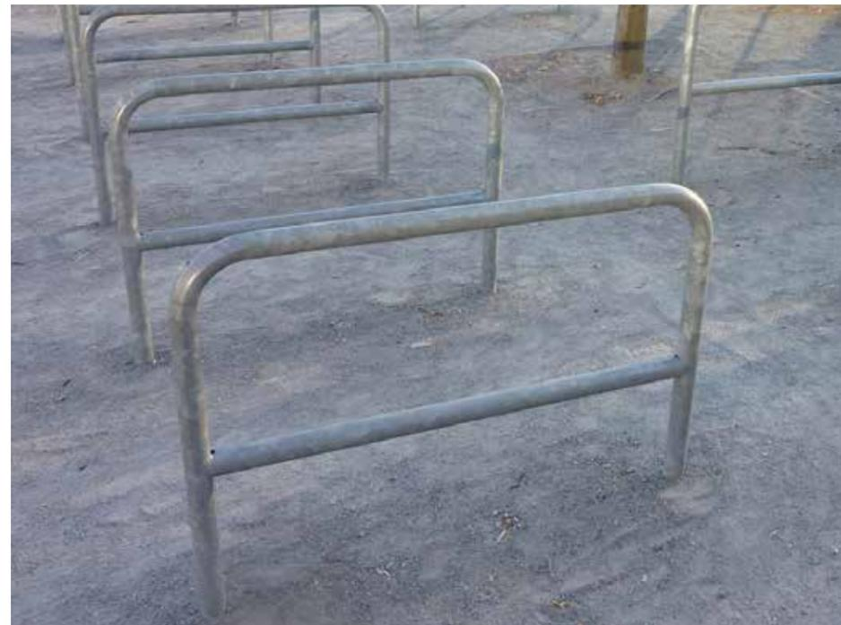
Beispielbild Fahrradanhlenbügel (Kreuzberger-Bügel) mit Mittelholm in feuerverzinktem Stahlrohr
